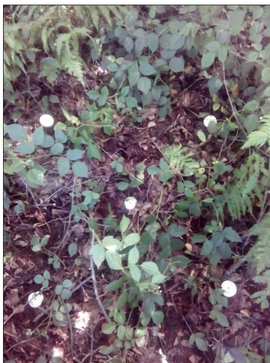
Označené odběrového místa (víčka od zavařovacích lahví jsou hřebem přibita do půdy - lze využít detektor kovů při hledání)
