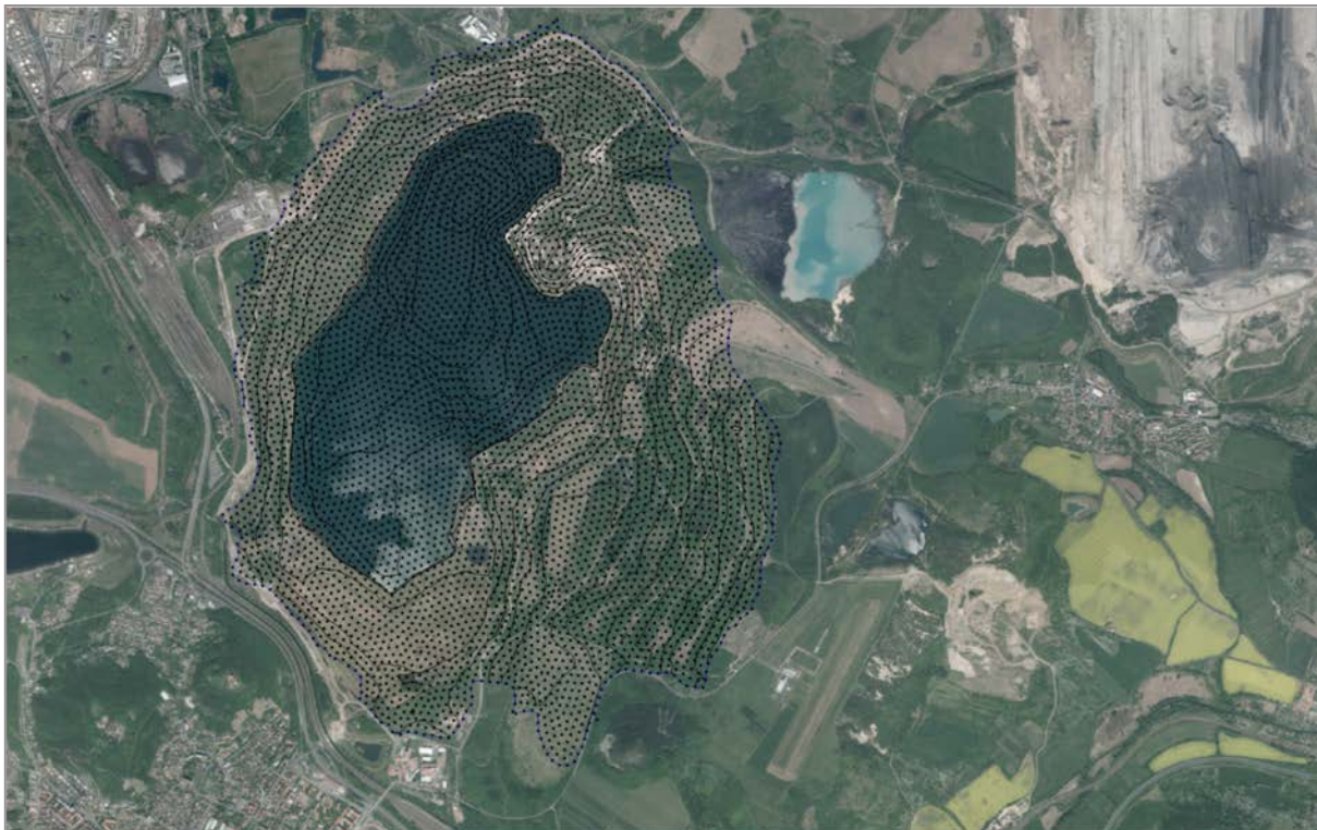
Obr. 5.16: Hranice modelované oblasti na podkladu ortofotomapy (zdroj ČÚZK) se schematickým znázorněním izolinií terénních výšek (v případě jezera Most báze)
