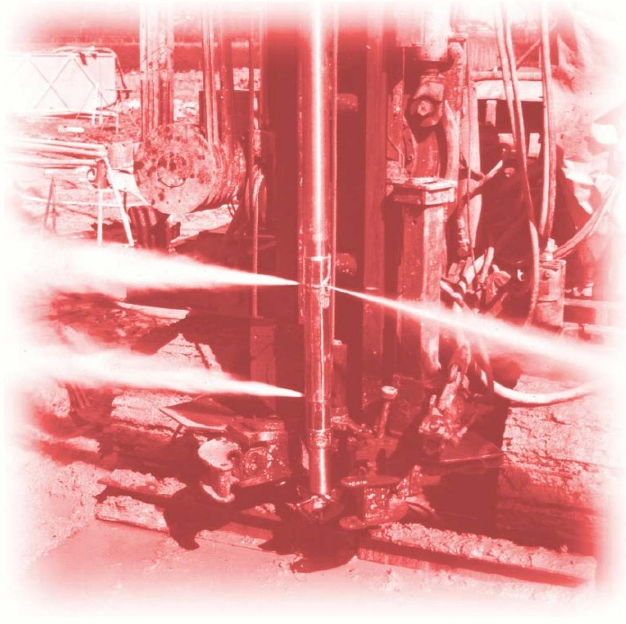
Ähnlich, ohne Umdrehungen des Gestänges während des Hochziehens, können im Boden auch Wandelemente herausgebildet werden, die insbesondere zur Eindämmung der Versickerung geeignet sind..
