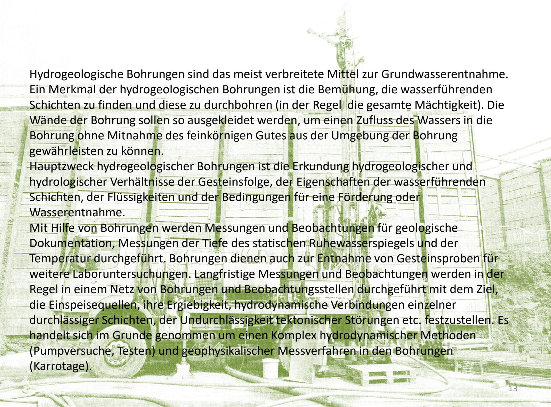
Hydrogeologische Bohrungen sind das meist verbreitete Mittel zur Grundwasserentnahme. Ein Merkmal der hydrogeologischen Bohrungen ist die Bemühung, die wasserführenden Schichten zu finden und diese zu durchbohren (in der Regel die gesamte Mächtigkeit). Die Wände der Bohrung sollen so ausgekleidet werden, um einen Zufluss des Wassers in die Bohrung ohne Mitnahme des feinkörnigen Gutes aus der Umgebung der Bohrung gewährleisten zu können.
