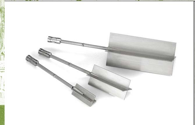
**Eine Drehsondierung** wird durch das drehen einer in den Boden eingetriebenen Flügelsonde durchgeführt, die aus vier Platten besteht, die zueinander um  $90^\circ$  verdreht sind. Eine Drehsondierung kann auch zur Bestimmung der **nichtentwässerten Festigkeit fester Tone, Stauberden und glazialer Tone** verwendet werden. Die Verlässlichkeit der Ergebnisse der Prüfung hängt vom Bodentyp ab.
