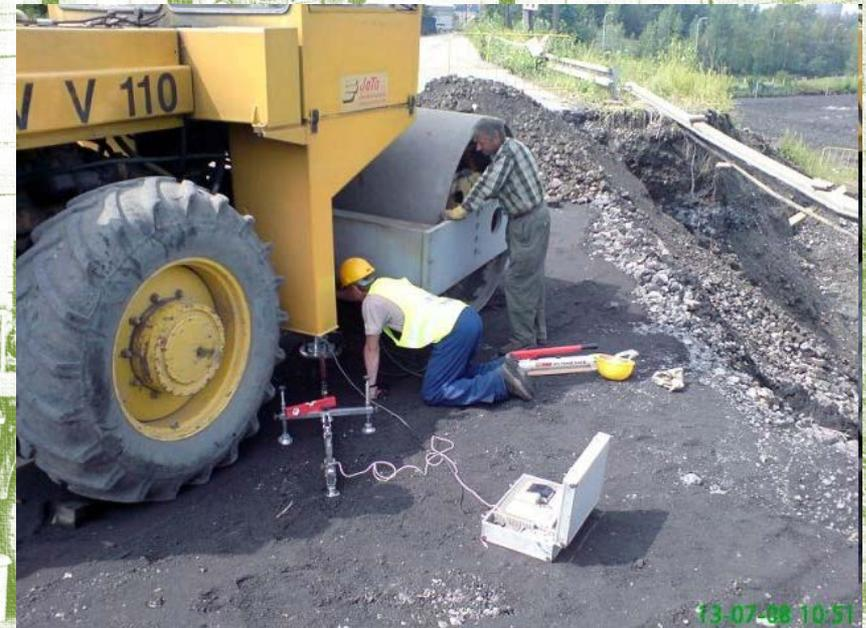
Der Wert des ersten Astes beschreibt den Typ (Qualität) der verwendeten Aufschüttung, der Wert des zweiten Astes zeigt dann auf die Möglichkeiten einer Nachverdichtung. Das Verhältnis beider Werte 4,0 und weniger wird im Fall einer Steinschüttung im Einklang mit der im Kap. 1.3 erwähnten Norm als eine ausreichende Verdichtung des eingesetzten Materials betrachtet.
