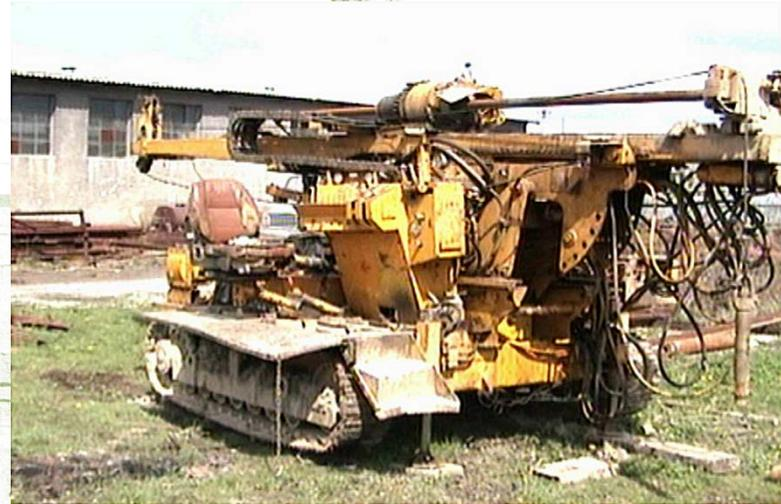
Bohranlage Diamec 250
