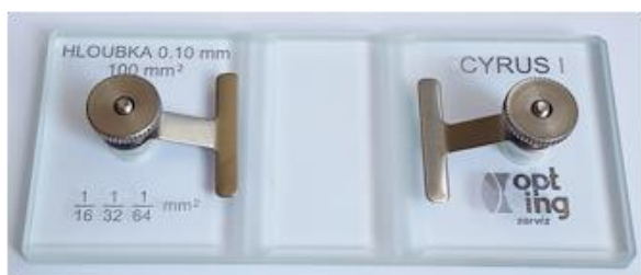
Počítací komůrka CYRUS I (vlevo) a Neubauerova počítací komůrka (vpravo)
