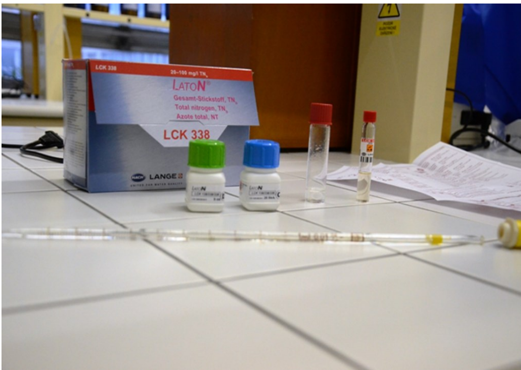
Laboratorní set HACH - LANGE ke stanovení celkového dusíku
